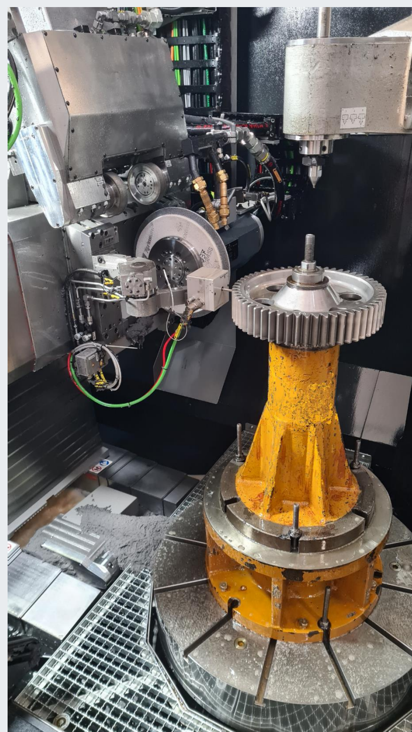
Fase di misurazione con unità a bordo macchina
